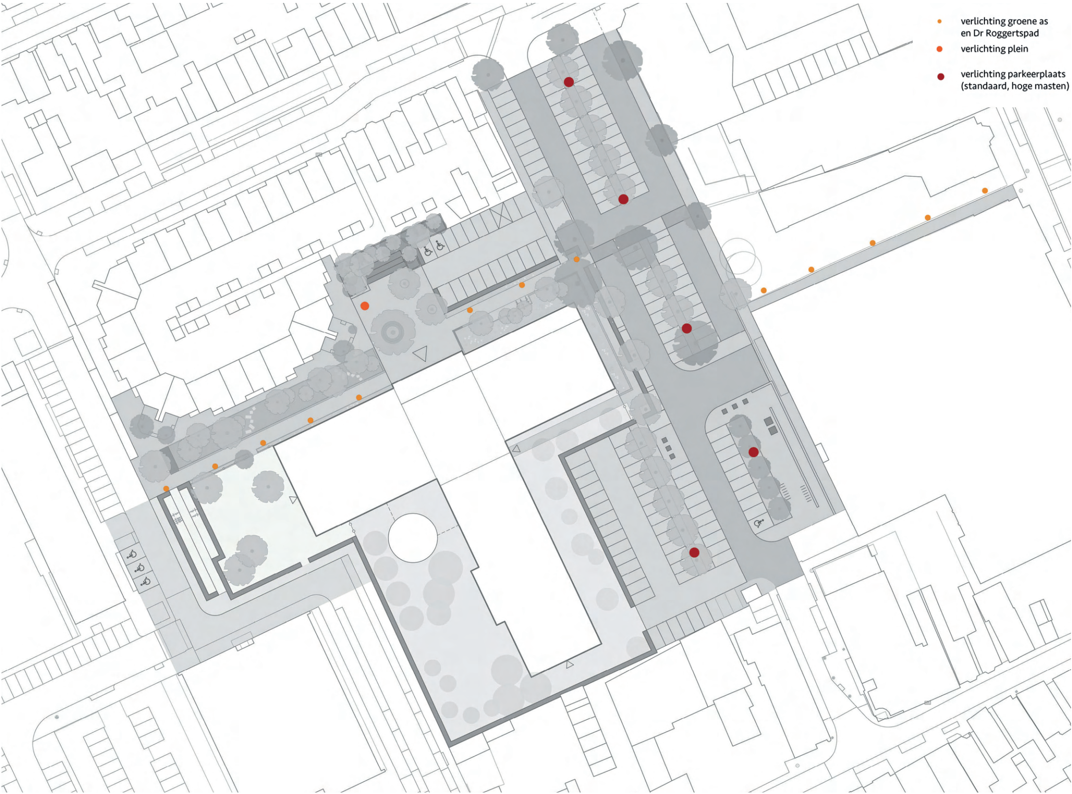
groene as conform Inverdan, type mast: paaltop mast: conisch naadloos getrokken hoogte: 3.5 m armatuur: Schreder Starlight LED
