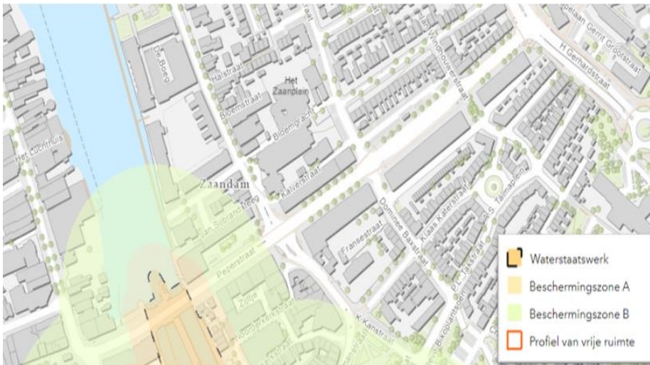
Figuur 3.2 Primaire waterkering met beschermingszone (bron: Legger Hollands Noorderkwartier)
