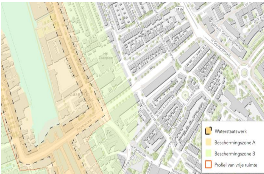
Figuur 3.3 Regionale waterkering met beschermingszone (bron: Legger Hollands Noorderkwartier)
