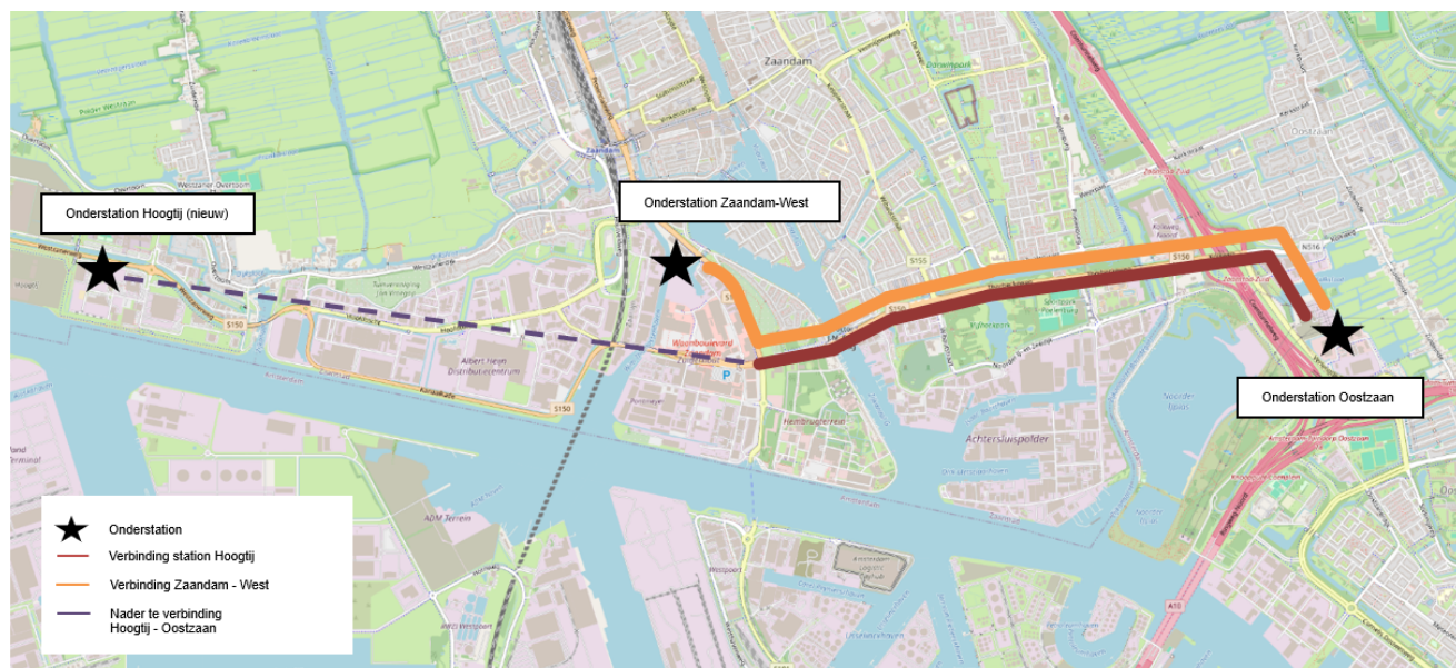
Figuur 2. Ondergrondse 50kv verbindingen tussen de onderstations
